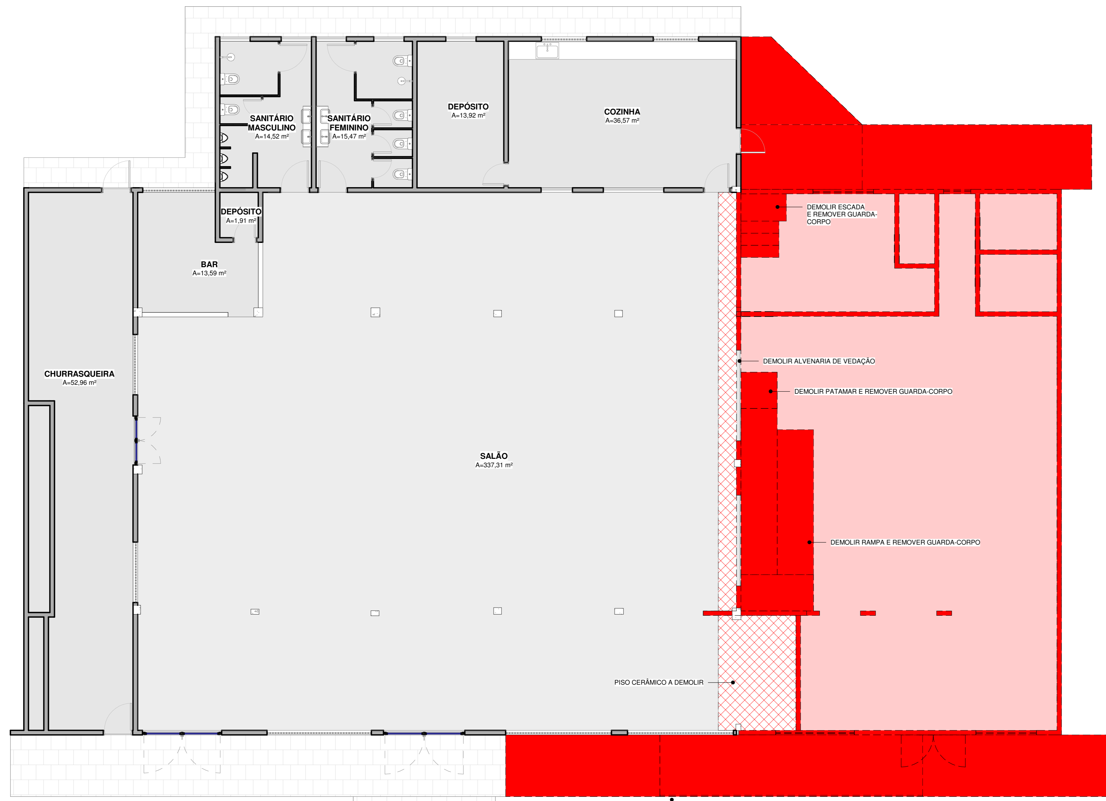
1 PLANTA BAIXA - REFORMA DEMOLIÇÃO 1 : 75
